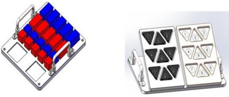
图2 码垛模块 + 搬运模块
