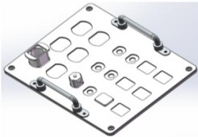
图 12 电机装配放置模块
